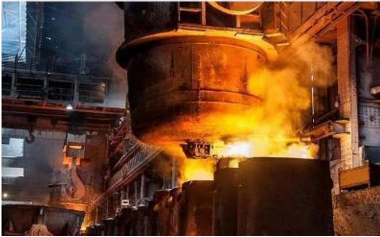
Schmelztemperatur Stahl bei 1500°C
